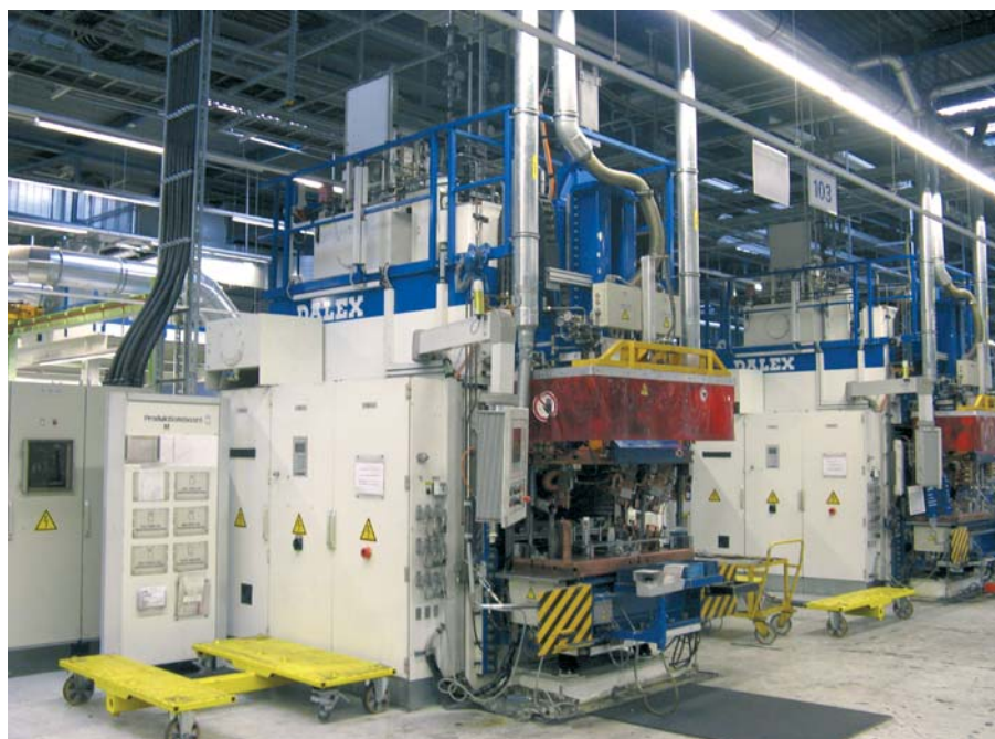
Bild 1. Elektrische Pressschweißmaschine im Einsatz in der Automobilindustrie
